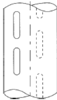
شکل ۲۴- لوله ایستاده شیاردار
