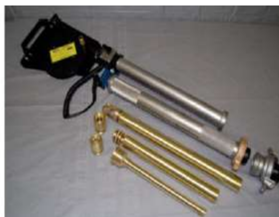
شکل ۴- مثال‌هایی از تجهیزات نمونه‌برداری بسته / محدود شده
