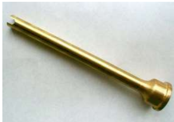
شکل ۲۳- مثالی از افزایش دهنده طول نازل ۲
