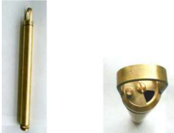
شکل ۲۸- انواع معمول نمونه بردار جریان محدود سیستم بسته
